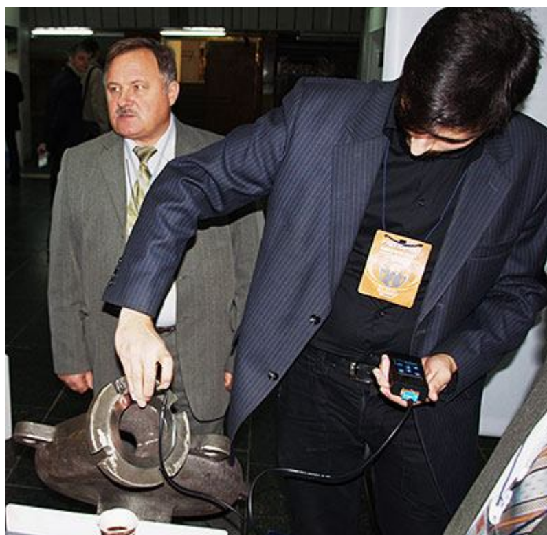
Один из посетителей с помощью специального прибора проводит замер твердости материала
