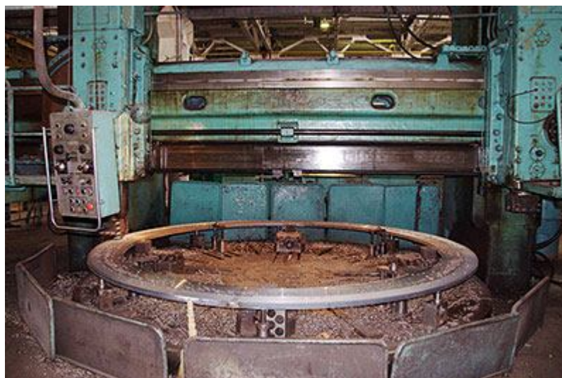
Сварную деталь обрабатывалась на токарно-карусельном станке модели «1550»
