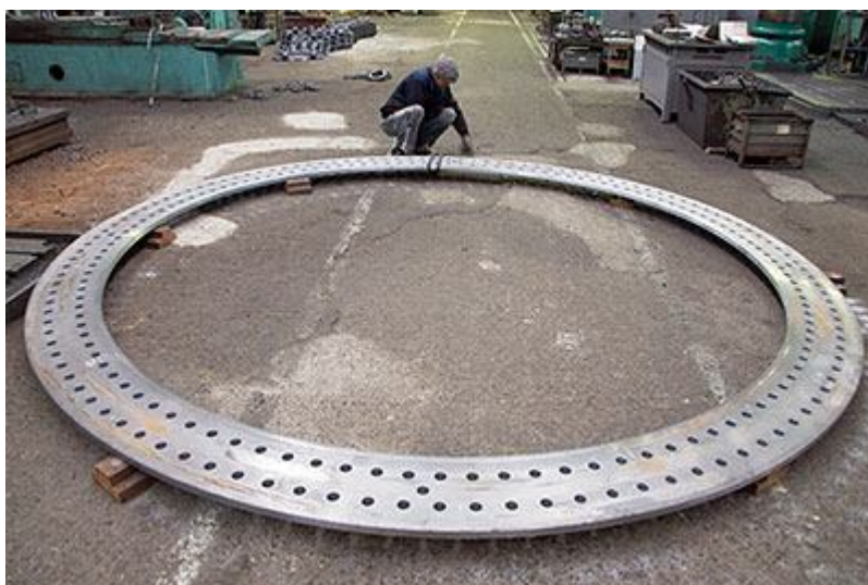
Эта деталь станет основанием в фундаменте ветроэнергетической установки
